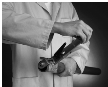
Снятие фаски с торцов труб
